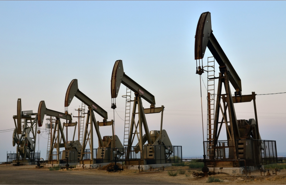
Poniżej: kiwony w Kalifornii – urządzenia służące do pompowania ropy naftowej ze złoża (fot. J. Ciccarelli, BLM, Public Domain Mark 1.0).
