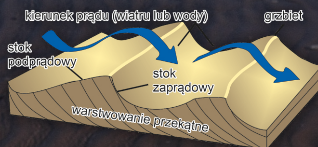
Schemat tworzenia się warstwowań przekątnych w wyniku przemieszczania się form dna w zbiorniku wodnym
